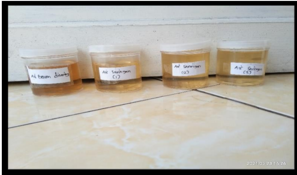
Gambar 3.2 Sampel air gambut sebelum dan sesudah filtrasi
