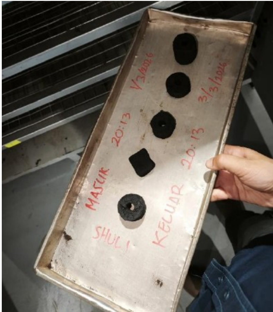
Gambar 11. Produk briket ampas kelapa yang telah dicetak dan siap uji
