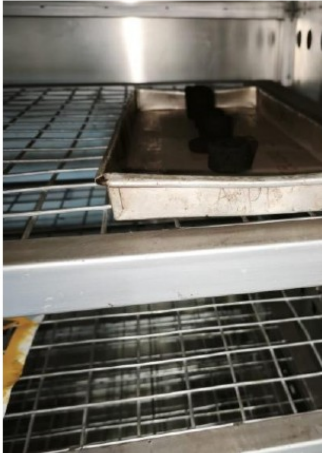
Gambar 10. Proses pengeringan akhir briket dalam oven
